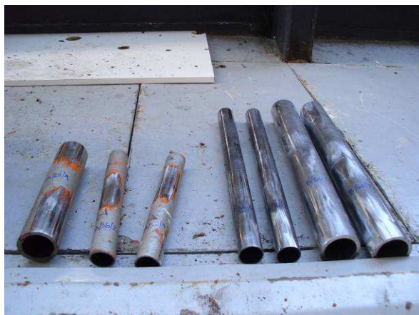
Obr. 11 Srovnávací vzorky „A“ a „B“ pro tvrdoměrná měření na ocelových trubkách.
