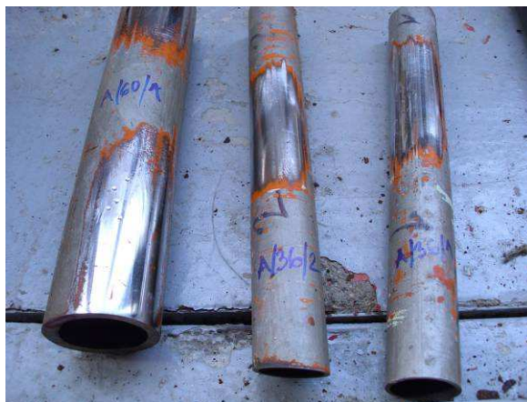
Obr. 12 Vzorky „A“ z oceli vyšší pevnostní třídy s vtisky po zkoušce Poldi.
